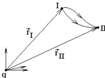
Пусть начало координат совпадает с зарядом  $q$ . Найдем работу  $dA'$  на малом участке пути  $d\vec{l}$ :
