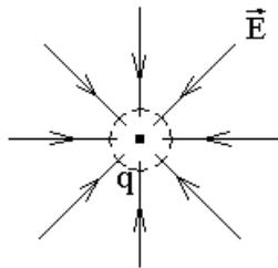
Из рисунка видно, что поток поля  $\vec{E}$  остальных зарядов через эту сферу отрицательный  $\Phi_E < 0$ , линии поля втекают в сферу. Это с одной стороны, а с другой стороны поток равен нулю  $\Phi_E = 0$ . И действительно, внутри малой сферы вокруг заряда  $q$  нет других зарядов, и для этих других зарядов  $Q = 0$ . Следовательно, для поля  $\vec{E}$  остальных зарядов, кроме заряда  $q$ , получим  $\Phi_E = 4\pi Q = 0$ .
