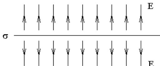
Это можно доказать, опираясь только на симметрию задачи и на скачок поля  $\vec{E}$  при переходе через заряженную поверхность:  $E_{2n} - E_{1n} = \frac{\sigma}{\epsilon_0}$ .
