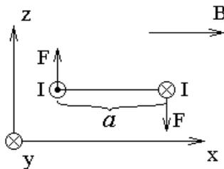
На отрезках рамки длиной  $a$ , которые направлены вдоль оси  $x$  и, соответственно, вдоль поля  $\vec{B}$ , сила Ампера равна нулю.
