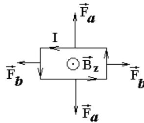
Из рисунка видно, что противоположно направленные силы попарно дают нулевой момент, как равные и противоположно направленные силы, действующие вдоль одной прямой. Следовательно,  $\vec{M} = 0$  для всех 4-х сил.
