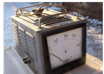
От сети переменного тока 220 Вольт на лабораторный автотрансформатор подается напряжение между клеммами обозначенными на рисунке, как "0 В" и "~220 В". Между клеммами "0 В" и "~250 В" можно снять напряжение 250 Вольт. Кроме трех рассмотренных отводов "0 В", "~220 В" и "~250 В" единственная (торOIDальная) обмотка лабораторного автотрансформатора имеет отвод в виде скользящего контакта. При перемещении контакта между
