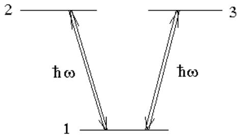
Мощное лазерное излучение с частотой  $\omega$  осуществляет оптическую накачку уровней энергии 2 и 3.
