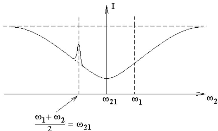
Рассмотрим традиционную схему спектроскопии насыщения поглощения, в которой излучение лазера проходит кювету с газом низкого давления, отражается зеркалом, проходит кювету с газом во встречном направлении и попадает на приемник излучения. Только будем рассматривать излучение импульсного лазера. Регистрируется резонансное увеличение мощности на приемнике при изменении несущей частоты лазерных импульсов.
