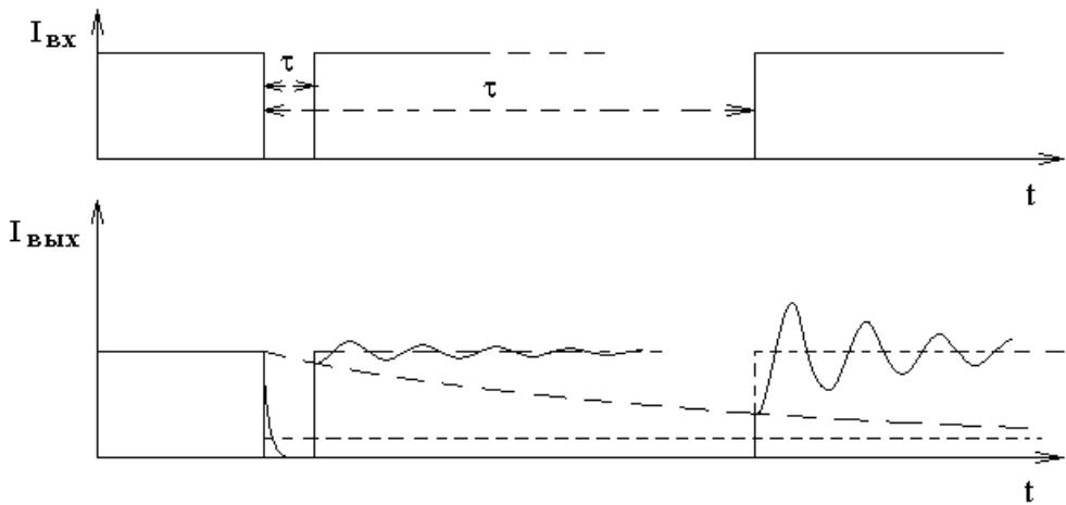
Если длительность импульса выключения светового поля мала, то амплитуда оптических нутаций стремится к нулю, так как в предельном случае нет импульса выключения и нет нутаций.
