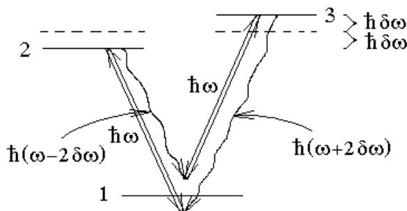
Как видно из рисунка, частоты фотонов спонтанных излучений, которые участвуют двухфотонных процессах равны  $\omega - 2\delta\omega$  и  $\omega + 2\delta\omega$ .
