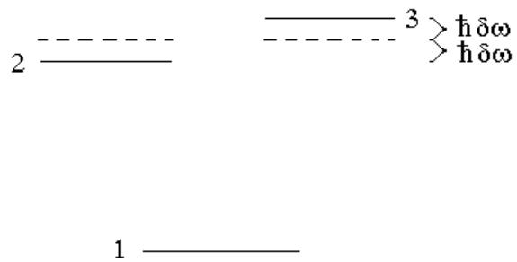
В интенсивности света на приемнике излучения после штарковского переключения частоты наблюдаются три сигнала разной природы.
