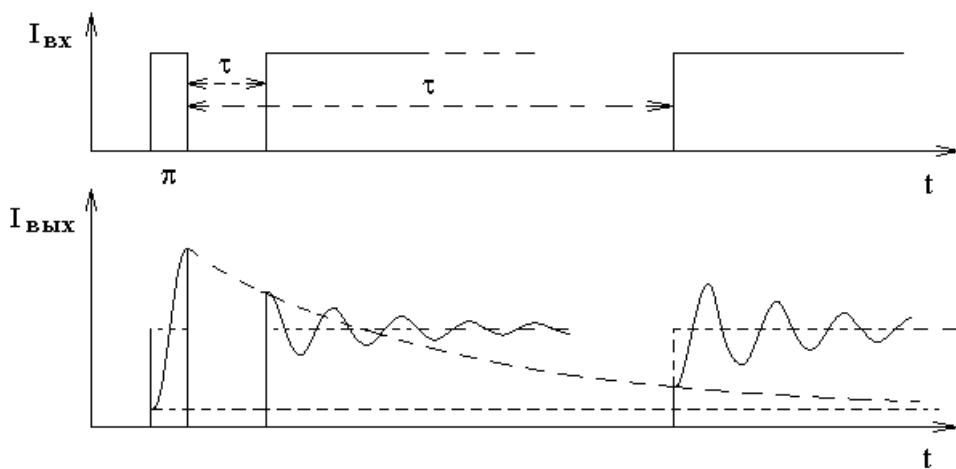
На верхнем рисунке после  $\pi$  импульса показаны два варианта задержки  $\tau$  между  $\pi$  импульсом и ступенькой включения светового поля.
