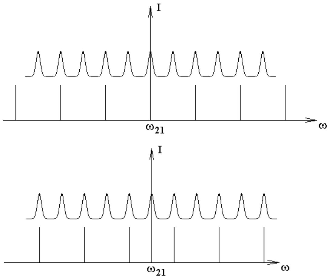
На рисунках приведена зависимость мощности на приемнике света, как функция несущей частоты спектрального комба — гребенки разрешенных продольных мод импульсного лазера. Гребенка движется по горизонтальной оси вместе с графиком зависимости мощности на приемнике. Максимумы мощности на приемнике соответствуют симметричным расположениям мод, как это изображено на двух графиках. Резонансы могут быть очень узкими (не
