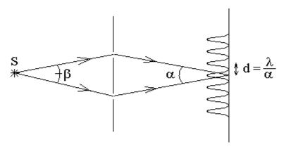
Чтобы интерференционные полосы не были слишком узкими, нужно чтобы скорость электронов была достаточной малой величиной, так как ширина полос  $d=\frac{\lambda}{\alpha}$  пропорциональна длине волны де Бройля  $\lambda=\frac{h}{mV}$ . В таком случае трудно создать пучок электронов с малым разбросом скоростей.
