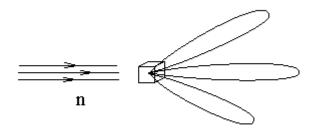
Если у ядер атомов кристалла отличный от нуля спин, то при рассеянии нейтронов кроме острых дифракционных максимумов присутствует слагаемое равномерного рассеяния по всем направлениям.
