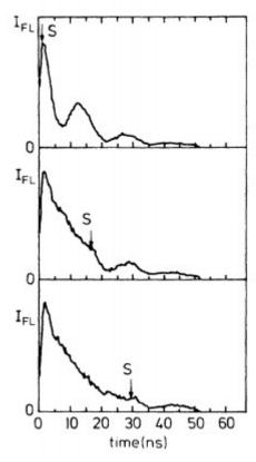
Можно подобрать такой световой импульс S, который переводит атомы из суперпозиционного нижнего состояния  $\psi_+$  в чистое нижнее состояние  $\psi_g$ , а из состояния  $\psi_-$  в состояние  $\psi_h$ . В эксперименте, начиная с момента светового импульса S, начинаются квантовые биения.
