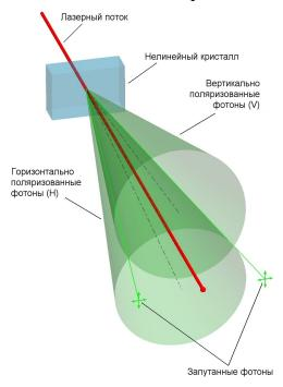
Для одних кристаллов генерируется пара фотонов одинаковой поляризации — это синхронизм первого типа, для других кристаллов генерируется пара фотонов ортогональной поляризации — это синхронизм второго типа.
