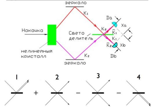
Два фотона одинаковой поляризации летят только в один и тот же приемник света, все равно в какой.
