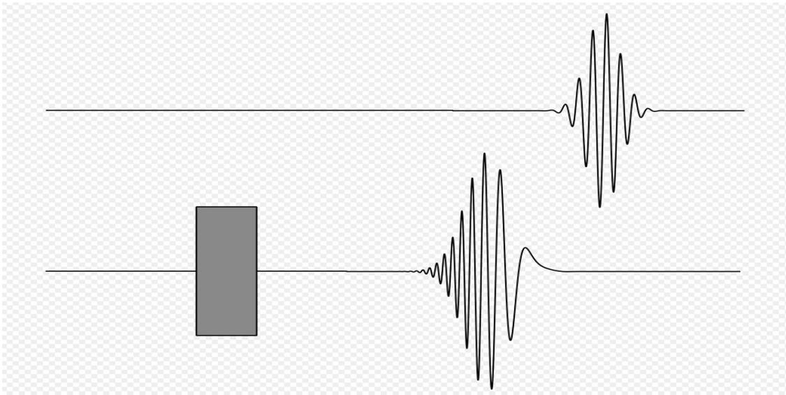
Если световой импульс пропустить через прозрачную среду с нормальной дисперсией, то низкие частоты импульса с меньшим показателем преломления проходят среду быстрее и оказываются в голове прошедшего светового импульса. Внутри линии поглощения — аномальная дисперсия света, и будет обратный эффект. Но внутри линии усиления дисперсия окажется нормальной, и эффект снова будет таким, как для прозрачной среды.
