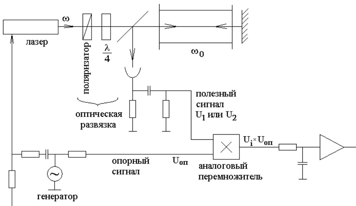
В этой схеме зависимость мощности сигнала на приемнике от частоты генерации лазера имеет следующий вид:
