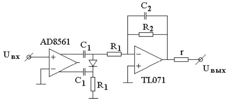
в которой короткие импульсы распространялись на очень малые расстояния (два конденсатора  $C_1 = 3\text{нФ}$  и диод между ними) и служили слабой передающей антенной для наводки;  $R_1 = 1\text{кОм}$ .
