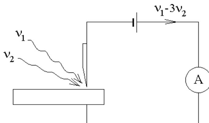
Это приемник, который реагирует на напряженность электрического поля световой волны, а не на интенсивность, как остальные приемники оптического диапазона. Например, в фототоке приемника можно получить сигнал на частоте  $\nu_1 - 3\nu_2$ , если эта частота достаточно низкая.
