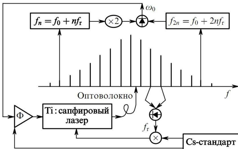
Лазерный импульс проходит по специальному стекловолокну. При этом импульс укорачивается, а его спектр расширяется так, чтобы в излучении присутствовали частоты, различающиеся в два раза. Излучение низкой частоты проходит нелинейный кристалл с удвоением частоты.
