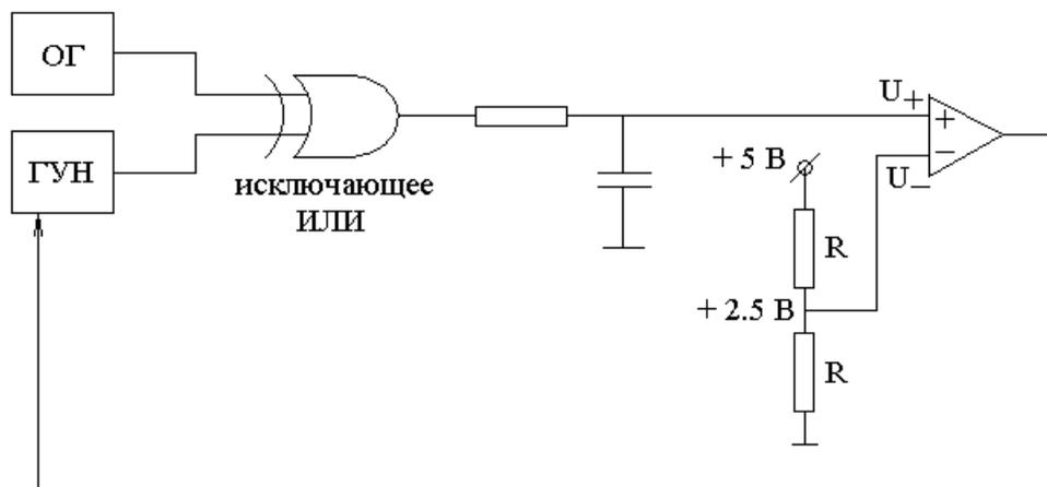
Здесь подразумевается, что оба генератора генерируют прямоугольное напряжение с логическими уровнями. Для получения такого сигнала частоту биений двух лазеров пропускают через компаратор, который положительное входное напряжение преобразует в логическую единицу, а отрицательную — в логический ноль. Таблица истинности для логических уровней микросхемы исключающее ИЛИ:
