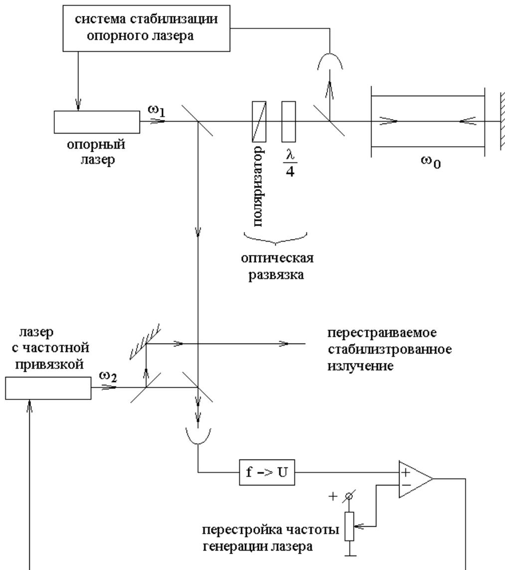
Здесь верхний так называемый опорный лазер стабилизирован по резонансу насыщения поглощения. Вся электронная часть системы стабилизации опорного лазера изображена одним прямоугольником.
