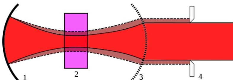
Этот принцип работает для диафрагмы 10 титан-сапфирового лазера. В результате происходит синхронизация мод лазера для формирования короткого импульса с большой интенсивностью света, так как именно такой импульс пройдет диафрагму с минимальными потерями.
