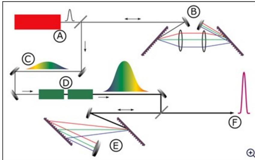
Свет проходит пару решеток (B) туда и обратно. Красный свет отклоняется решетками сильнее и длина пути для него меньше, чем для синего света. В результате импульс растягивается во времени. В голове импульса бегут низкие частоты (красный свет). Это процесс чирпирования импульса.
