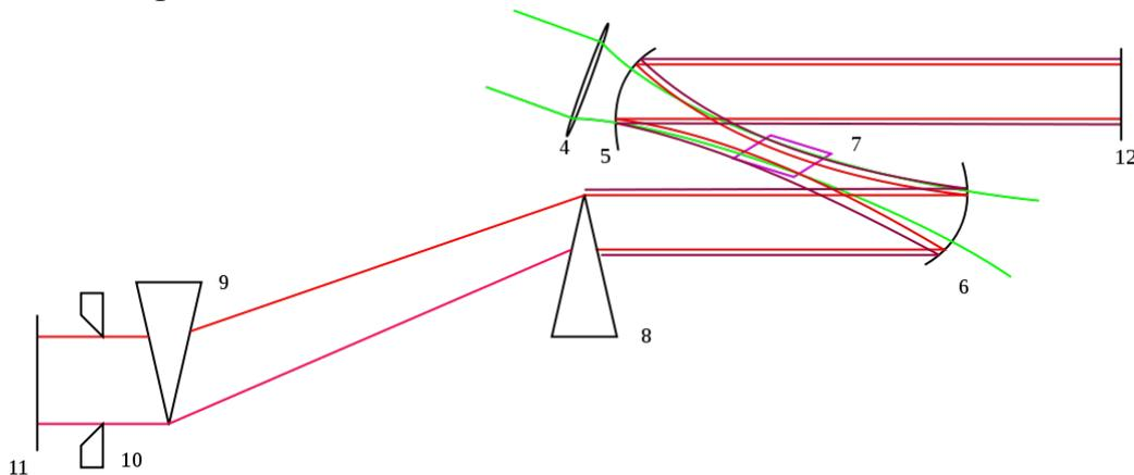
Накачка аргоновым лазером. Призмы для компенсации дисперсии групповых скоростей (ДГС) — control of group velocity dispersion. Положение диафрагмы 10 по вертикали — перестройка средней длины волны по контуру линии усиления. Диаметр диафрагмы 10 — для настройки длительности импульса.
