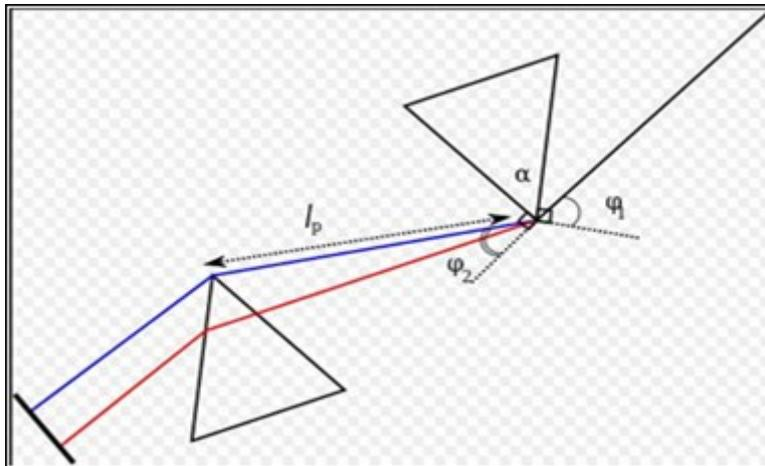
Здесь красный свет долго проходит внутри призмы. Для красного луча получается большая длина оптического пути. Красный свет задерживается относительно синего света и компенсирует дисперсию групповых скоростей.
