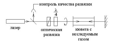
Поляризатор на оптической схеме принято обозначать, как клееную призму, намекая на призмы Николя и Волластона.
