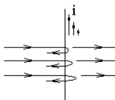
Излучение этих токов вглубь зеркала (направо) синфазно друг другу и полностью гасит прошедшую падающую волну. Излучения различных слоев тока в обратном направлении (налево) имеют несколько различные фазы, так как свет проходит до очередной плоскости с током и обратно различные расстояния. Волны, излученные назад, не совсем синфазны, не вполне усиливают друг друга. Поэтому отраженная от зеркала волна по амплитуде
