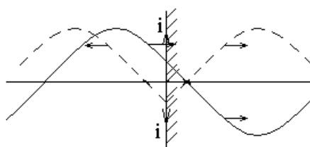
По поверхности зеркала течет переменный ток  $i$  с оптической частотой. Этот ток излучает плоскую электромагнитную волну одинаково направо и налево в обе стороны от поверхности зеркала. Волна, излученная направо в глубину зеркала (изображена пунктиром), интерферирует с прошедшей сквозь зеркало падающей волной (сплошная линия) и полностью ее гасит.
