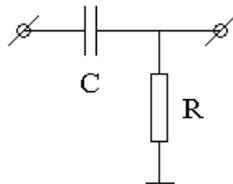
Пусть напряжение  $U_{\text{вх}}(t)$  на входе схемы — любая функция времени. Входное напряжение подается на последовательно включенные конденсатор  $C$  и резистор  $R$ , а с резистора снимается напряжение  $U_{\text{вых}}(t)$ . И пусть в любой момент времени выполнено условие  $|U_{\text{вых}}(t)| \ll |U_{\text{вх}}(t)|$ . Подразумевается, что ток на выходе схемы равен нулю, то есть к выходу ничего не подключено.
