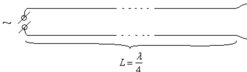
Пусть длина двухпроводной линии  $L = \frac{\lambda}{4} = 1500$  км. В таком случае оказывается, что короткое замыкание на удаленном конце линии будет восприниматься источником напряжения, как разрыв, а не как короткое замыкание.
