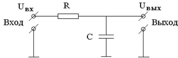
Надписи  $U_{вх}$  и  $U_{вых}$  можно не делать, так как обычно подразумевается, что напряжение подается на верхнюю клемму пары входных клемм и снимается тоже с верхней клеммы пары выходных клемм.
