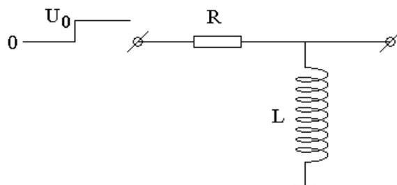
Пусть резистор и катушка индуктивности включены последовательно. На эту схему в нулевой момент времени подают ступеньку напряжения величиной  $U_0$ . Нужно найти напряжение на катушке индуктивности, как функцию времени.
