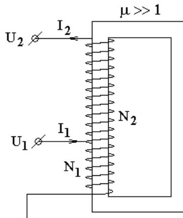
На приведенном рисунке первичная обмотка трансформатора представляет собой часть вторичной обмотки, а вторичная обмотка — это вся обмотка трансформатора. Автотрансформатор можно включить и наоборот.
