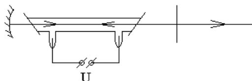
Мы для простоты рассмотрим резонатор лазера с двумя плоскими зеркалами.
