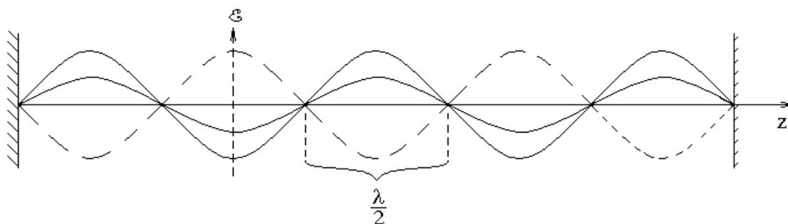
В резонаторе работающего лазера присутствует стоячая волна. На зеркалах лазера находятся узлы стоячей волны. Следовательно, на длине резонатора  $L$  укладывается целое число полуволин  $L = m \frac{\lambda}{2}$ , где  $m = 1, 2, 3, \dots$  — целое число. Лазер может излучать только такой свет, длина волны  $\lambda$  которого удовлетворяет равенству  $L = m \frac{\lambda}{2}$ .
