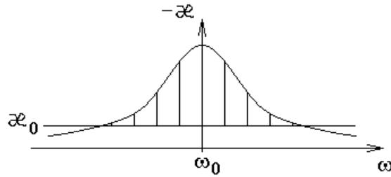
если ширина спектральной линии усиления определяется эффектом Доплера. Здесь длины вертикальных отрезков пропорциональны величине мощности излучения лазера на соответствующих частотах.
