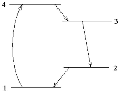
В плазме газового разряда свободные электроны ускоряются электрическим полем, ударяются о нейтральные атомы газа и, передавая часть энергии атому, переводят его из состояния с уровнем энергии 1 в состояние с уровнем энергии 4. Обратный процесс перехода атома при столкновении с электроном с уровня 4 на уровень 1 тоже присутствует, но нас интересовать не будет.
