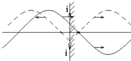
По поверхности зеркала течет переменный ток  $i$  с оптической частотой. Этот ток излучает плоскую электромагнитную волну одинаково направо и налево в обе стороны от поверхности зеркала. Волна, излученная направо в глубину зеркала (изображена пунктиром), интерферирует с прошедшей сквозь зеркало падающей волной (сплошная линия) и полностью ее гасит. Следовательно, плоскость токов излучает направо волну со сдвигом фазы  $\pi$  по отношению к проходящей сквозь зеркало волне.
