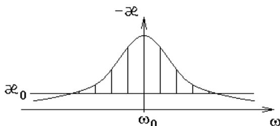
В случае доплеровского уширения линии усиления лазер излучает на всех отмеченных частотах одновременно.
