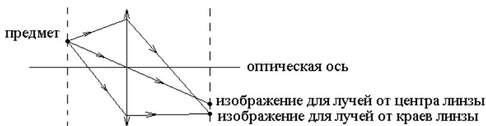
В этом случае изображение точечного предмета имеет форму вертикального отрезка.
