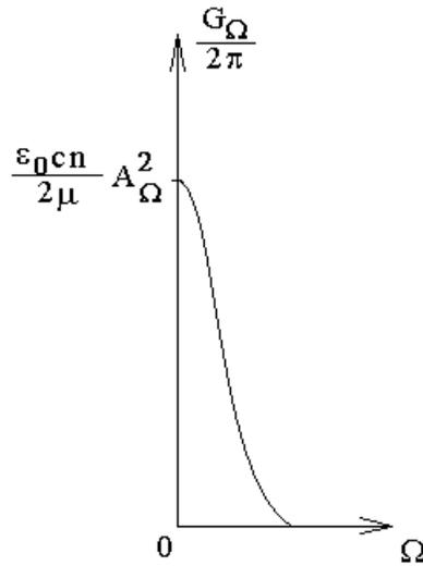
Здесь  $G_\omega = 2\pi \frac{\epsilon_0 c n}{2\mu} |\tilde{E}_0(\omega)|^2$  — спектр света или спектральная плотность поверхностной плотности энергии,  $|\tilde{E}_0(\Omega)| = A_\Omega$  — модуль фурье-образа огибающей.
