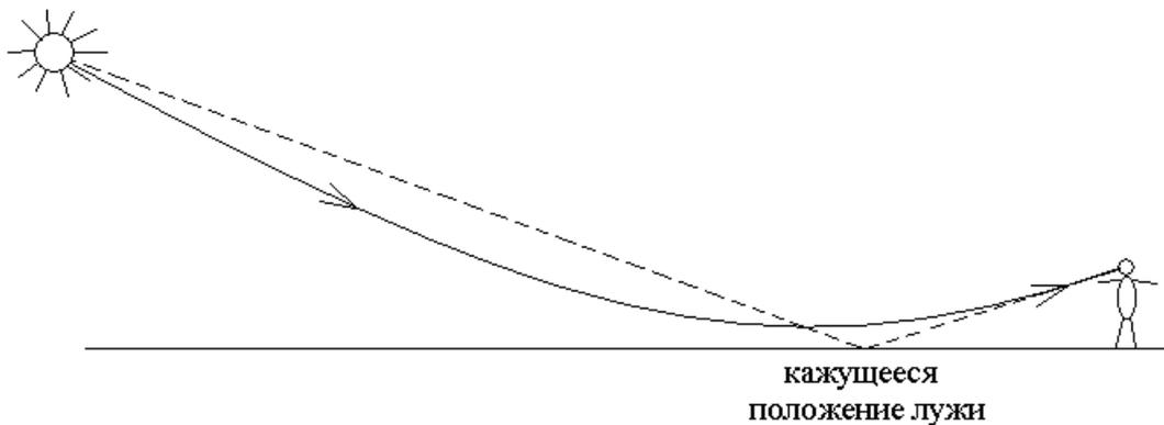
При скользющем падении света свет поворачивает у поверхности асфальта, как бы отражаясь от лужи. В этой луже, которой на самом деле нет, видны отражения неба, солнца, деревьев или фар автомобиля.
