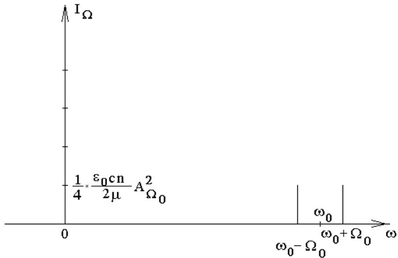
Интенсивности линий спектра становятся еще вдвое меньше. Причина еще одного коэффициента  $\frac{1}{2}$  вызвана тем, что световой импульс в сравнении с огибающей имеет множитель  $\cos(\omega_0 t)$ , а интенсивность при этом имеет множитель  $\langle \cos^2(\omega_0 t) \rangle_t = \frac{1}{2}$ .
